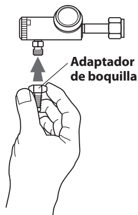
Conecte el adaptador de boquilla a la salida del regulador de oxígeno
